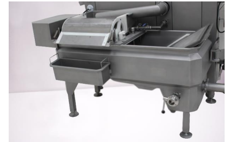
Tanque de recirculación y enfriamiento
